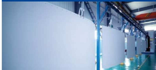
连续式搪烧隧道炉
