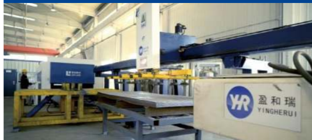
精准化激光切割机
